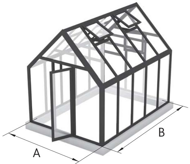
Для установки теплиц на сухих и ровных участках рекомендуем соорудить бетонный ленточный фундамент. Он послужит надежной опорой и продлит срок эксплуатации конструкции. Сделать самому фундамент под теплицу не составит больших проблем. Для теплицы размером **AхB** мм рекомендуется подготовить фундамент со следующими габаритами:
